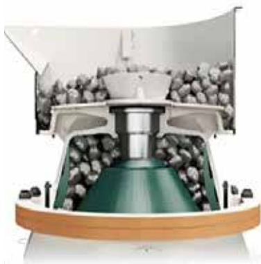
Guter Füllstand und gute Verteilung des Aufgabematerials.
